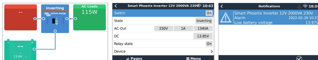
Příklad obrazovek zařízení GX zleva doprava: obrazovka systému, obrazovka střídače a zpráva o alarmu.
